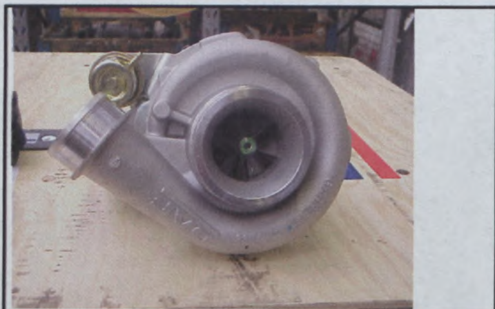
M) Vue de côté du turbocompresseur Side view of turbocharger
