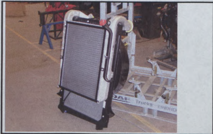
R) Echangeur intermédiaire déposé Intercooler dismantled
