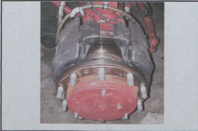
V-1) Frein avant 1 Front 1 brake
