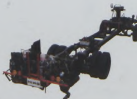
HINO RK-model bus chassis: GVMR 14,000 kg RK型バスシャシー
