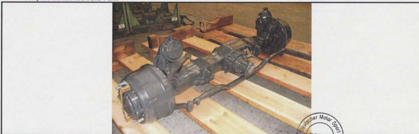
X-1) Dessin de l'essieu avant avec suspension, amortisseurs et butées en matériau élastique Drawing of the front axle with suspension, shock absorbers and elastic bump stops
