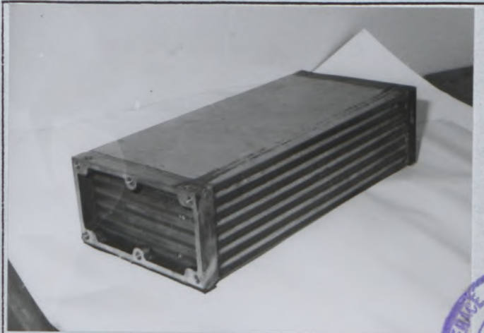
R) Echangeur intermédiaire déposé Intercooler dismantled
