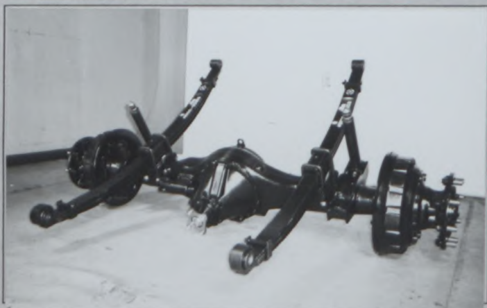
U1) Train arrière 1 complet déposé Complete dismantled rear 1 axle 取り外したリアアクセル一式
