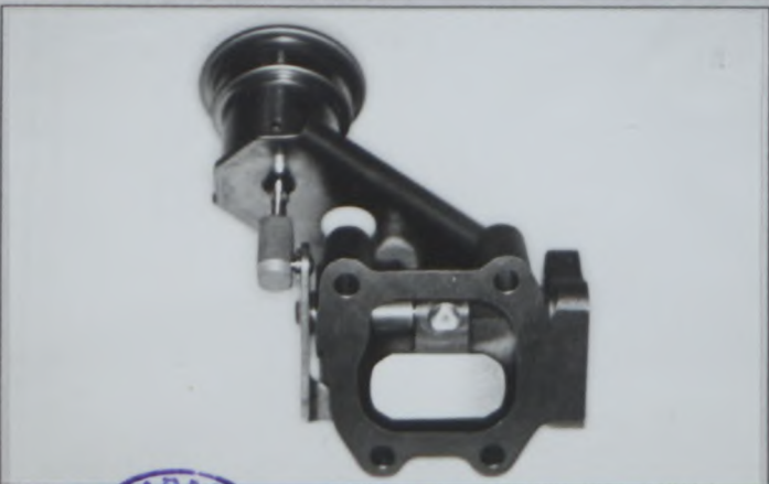
O) Soupape et montage du by-pass du turbocompresseur Valve and by-pass installation of turbocharger バypassとバypassのターボチャージャーへの取付位置
