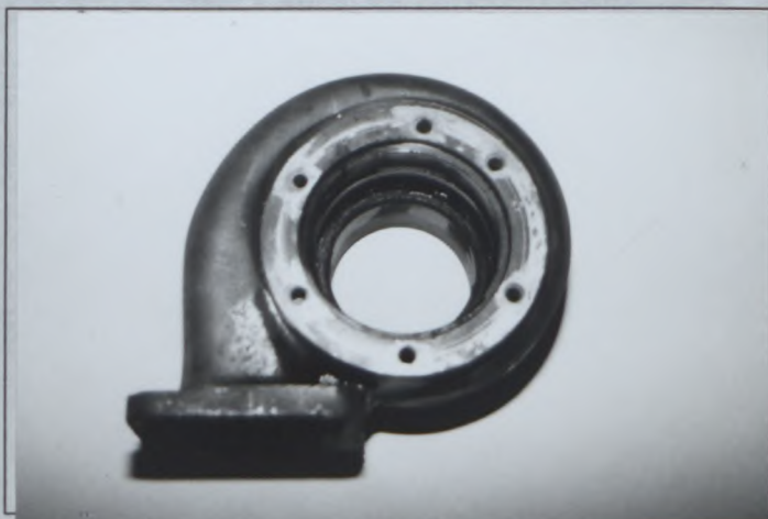
P) Système d'échappement entre collecteur et turbocompresseur Exhaust system between manifold and turbocharger ターボコンプレッサとマニホールド間の排気方式
