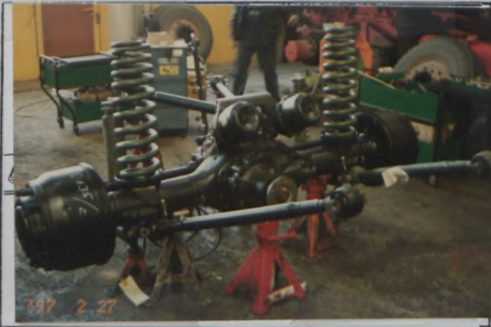
U1) Train arrière 1 complet déposé Complete dismantled rear 1 axle
