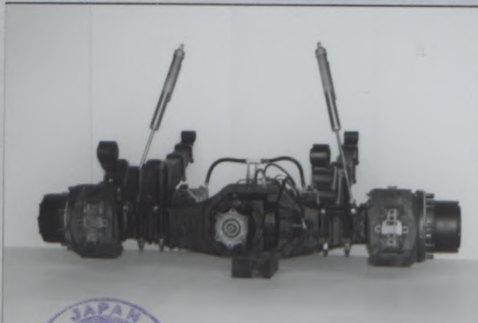
U1) Train arrière 1 complet déposé / Complete dismounted rear 1 axle / 取り外したリア1アクスルー式
