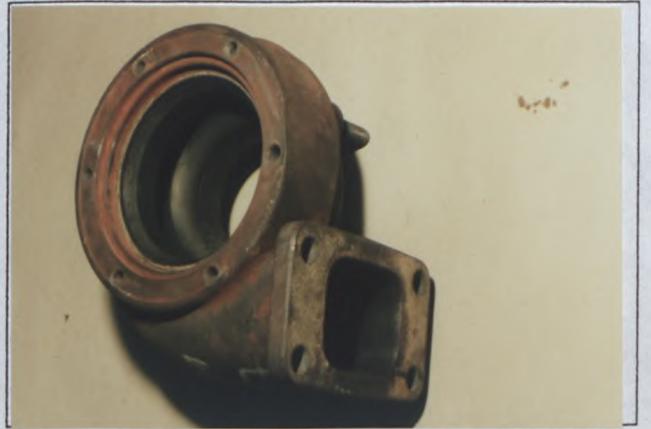
N) Carter de turbine du turbocompresseur Turbine housing of turbocharger
