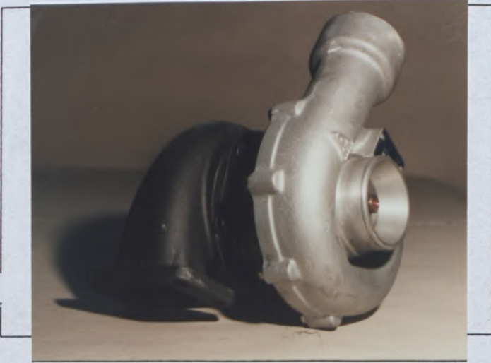
K) Vue de dessus du turbocompresseur Plan view of turbocharger
