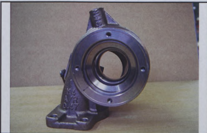
O) Soupape et montage du by-pass du turbocompresseur Valve and by-pass installation of turbocharger
