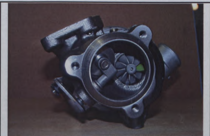
O) Soupape et montage du by-pass du turbocompresseur Valve and by-pass installation of turbocharger
