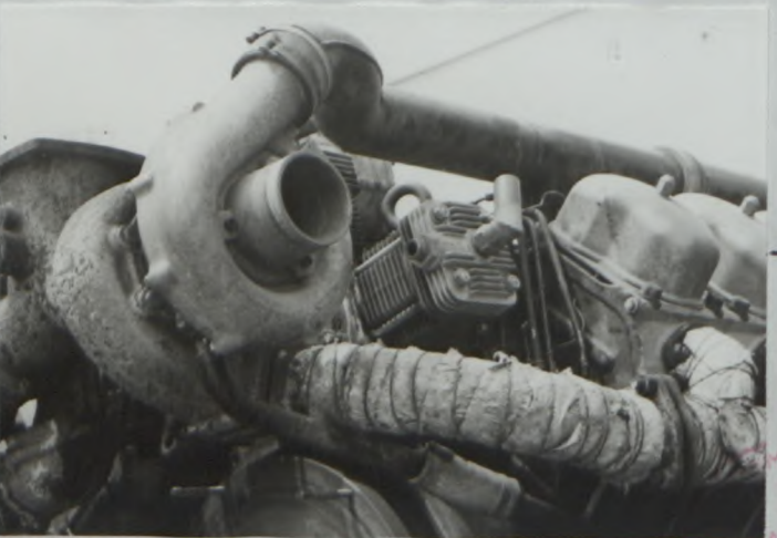
O) Soupape et montage du by-pass du turbocompresseur Valve and by-pass installation of turbocharger
