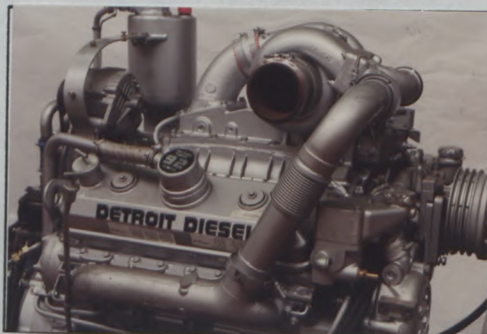
P) Système d'échappement entre collecteur et turbocompresseur Exhaust system between manifold and turbocharger
