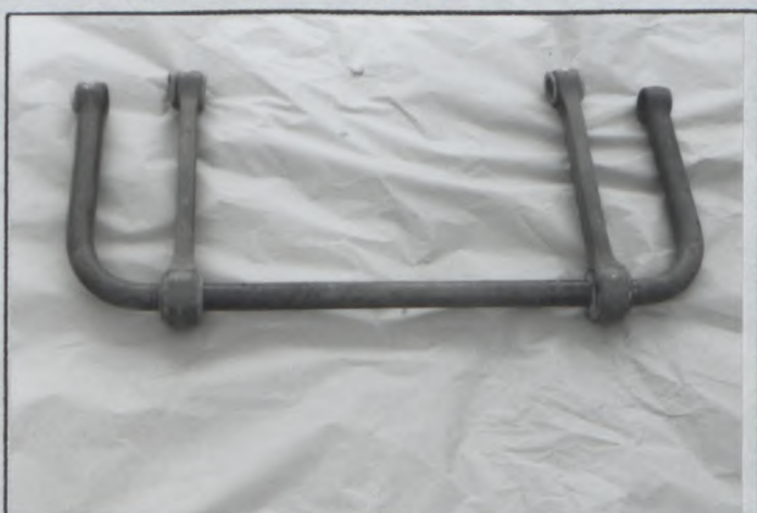
XI-1) Dessin ou photo du stabilisateur avant 1 Drawing or photo of front 1 stabiliser
