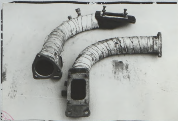
BB) Echappement complet Complete exhaust system
