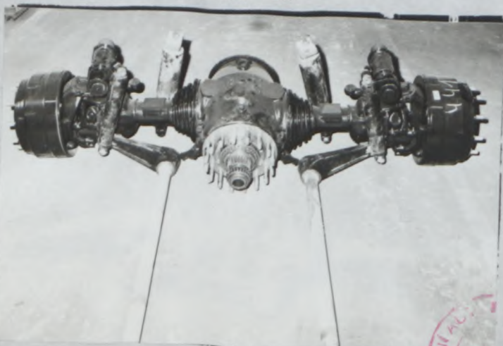
T1) Train avant 1 complet déposé Complete dismantled front 1 axle
