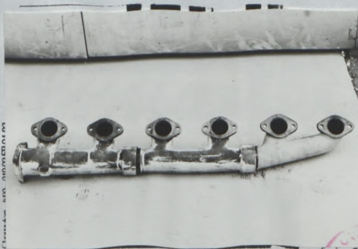
J) Collecteur d'échappement Exhaust manifold
