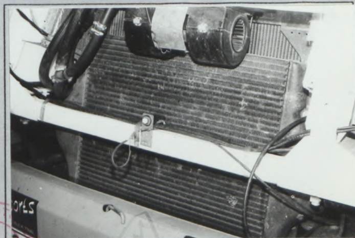
Z) Echangeur intermédiaire monté Intercooler mounted
