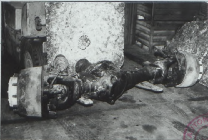
T1) Train avant 1 complet déposé Complete dismantled front 1 axle
