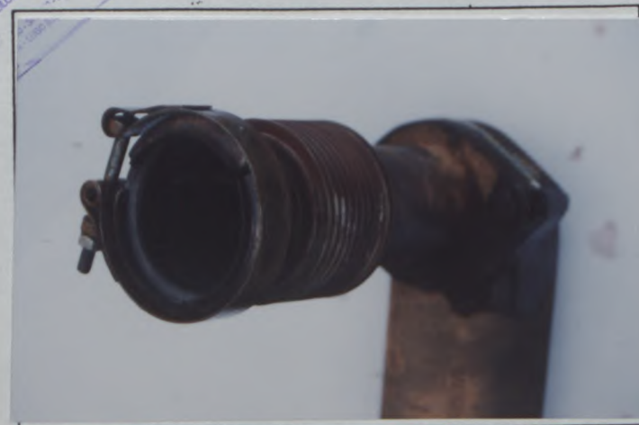
P) Systeme d'echappement entre collecteur et turbocompresseur Exhaust system between manifold and turbocharger
