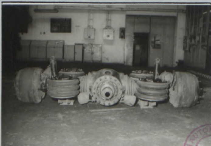
U1) Train arrière 1 complet déposé Complete dismantled rear 1 axle
