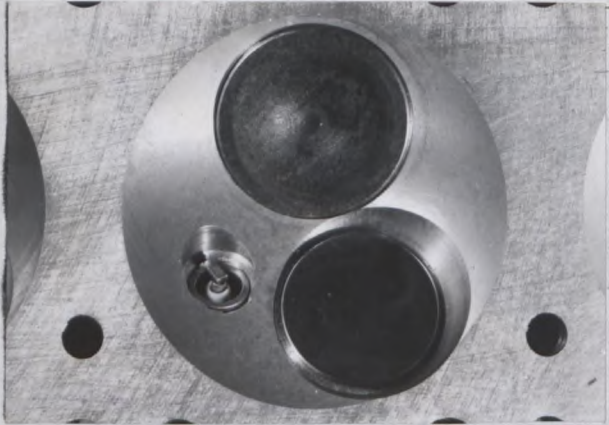
Photo K ヘッドの燃焼室 Combustion chamber in head.
