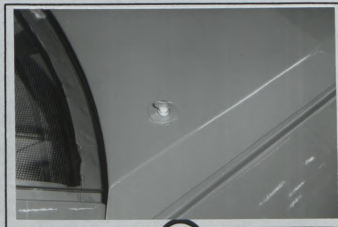
A6) Déverrouillage de capot arrière (Modèle de compétition) Rear cover release (Competition model)
