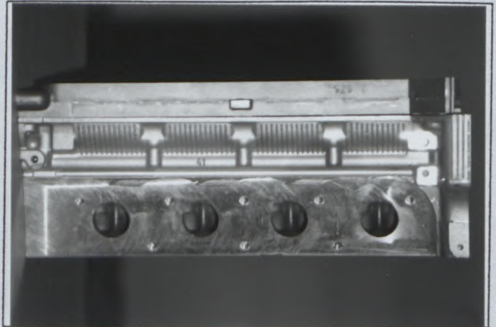
F2) Profil gauche de culasse nue Left hand view of bare cylinderhead
