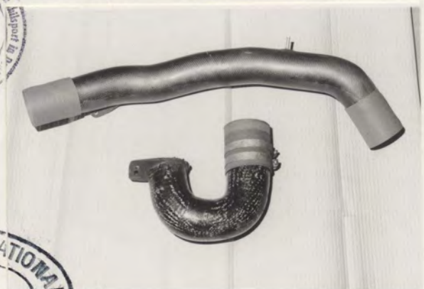
R)+S) Kunststoffverbindungsrohr Turbolader - Luft filter/plastic crossover pipe turbocharger - air induction box und Ladeluftkühler-Saugrohr and intercooler - inlet manifold
