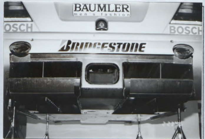
A4) Dessous arrière (Modèle de compétition) Rear part of underbody (Competition model)
