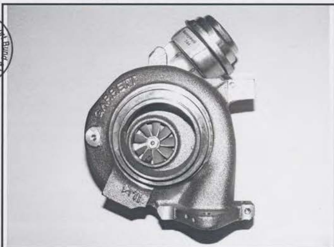
N) Carter de turbine du turbocompresseur Turbine housing of turbocharger
