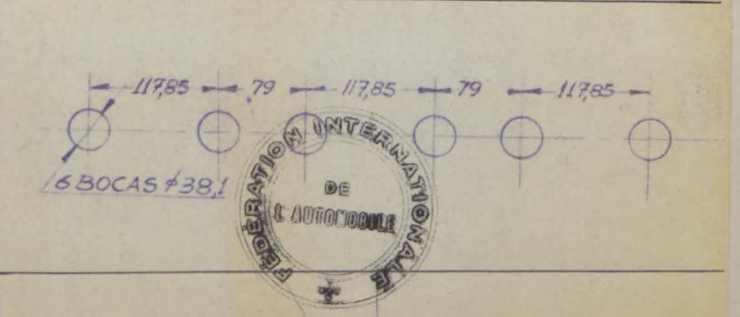
Dessin orifices échappement culasse face collecteur. Indiquez dimensions ou échelle et tolérance de fabrication.
