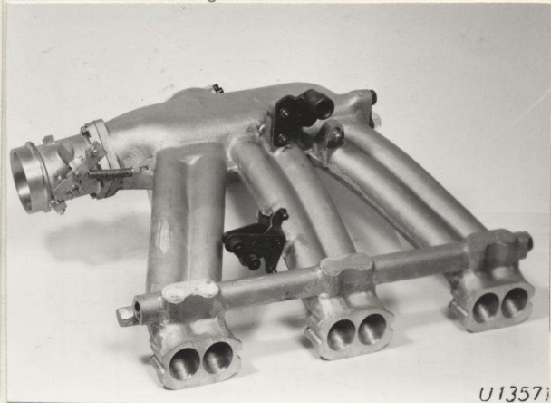
Foto des Ansaugrohres
