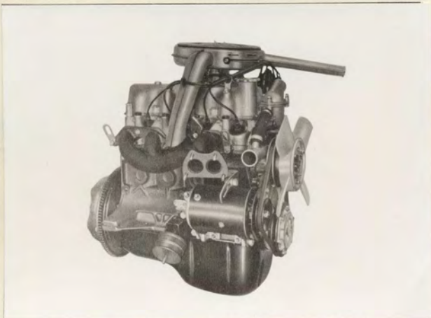
Motor mit Aggregaten von rechts (ohne Getriebe)
