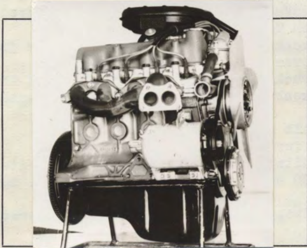
Motor mit Aggregaten von rechts (ohne Getriebe)
