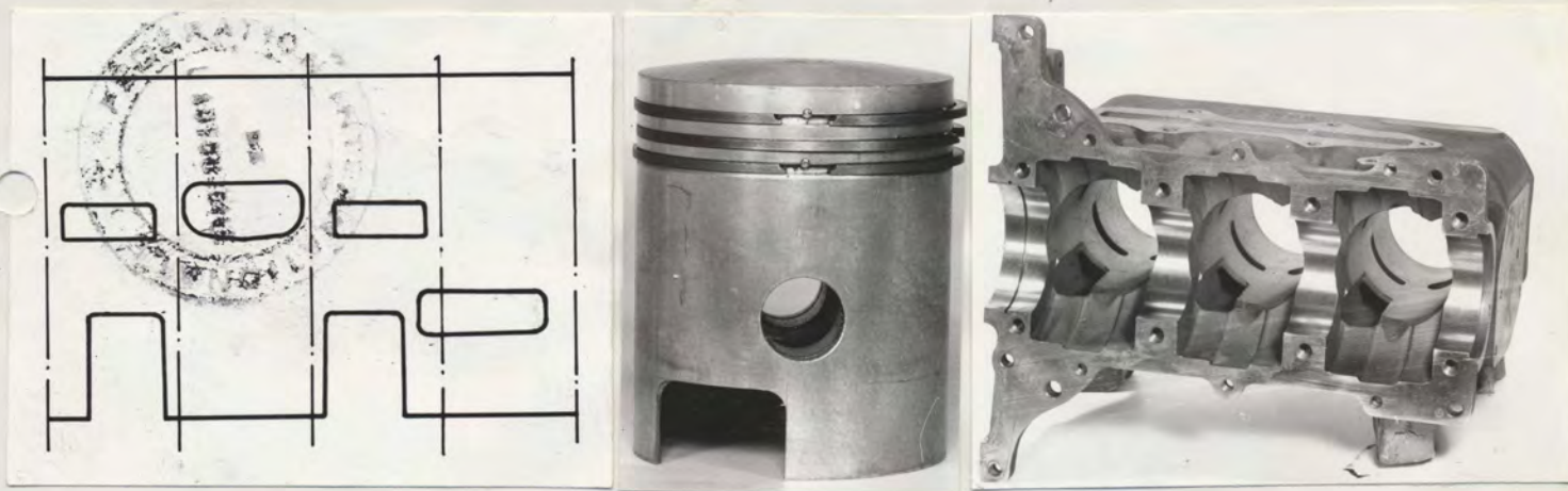
Zeichnung der Zylinderkanäle Foto des Zylinderblocks und Kolbens
