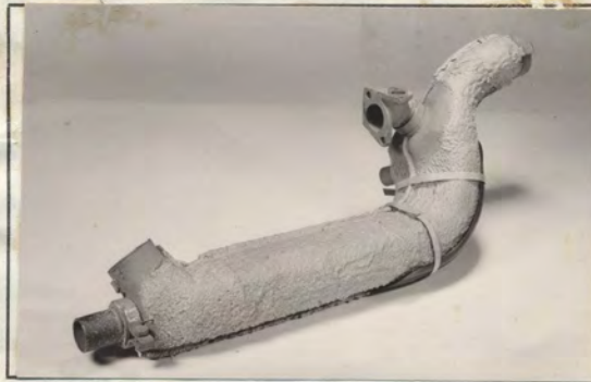
Foto des Auspuffkrümmers
