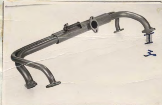
Foto des Ansaugrohres
