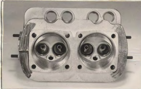
Foto der Verbrennungskammern
