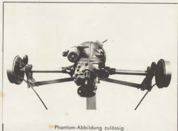
Phantom-Abbildung zulässig Hinterachse kompl. (ohne Räder)
