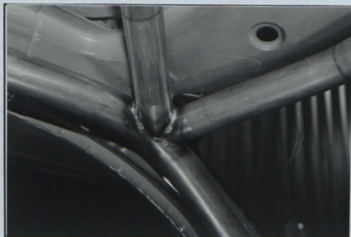
PHOTO N° 03 arceau avant supérieur gauche
