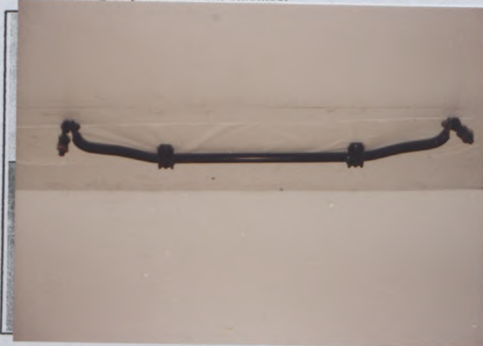
XI) Dessin ou photo du stabilisateur avant Drawing or photo of front stabiliser
