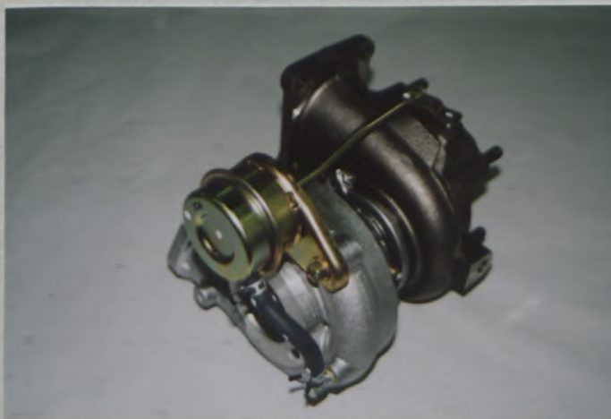
o) Soupape et montage du by-pass du turbocompresseur Valve and by-pass installation of turbocharger バルブとバイパスのターボチャージャーへの取付位置
