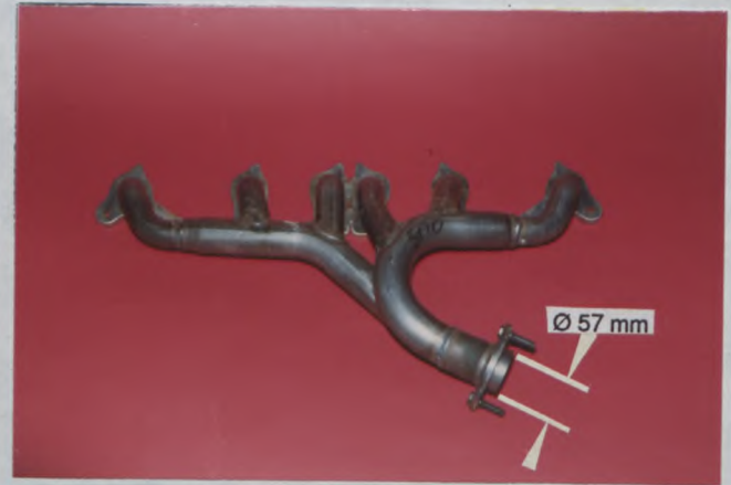
J) Collecteur d'échappement Exhaust manifold
