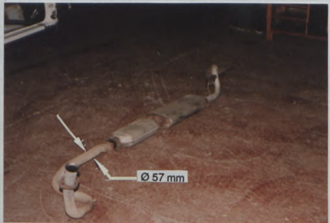
BB) Echappement complet Complete exhaust system
