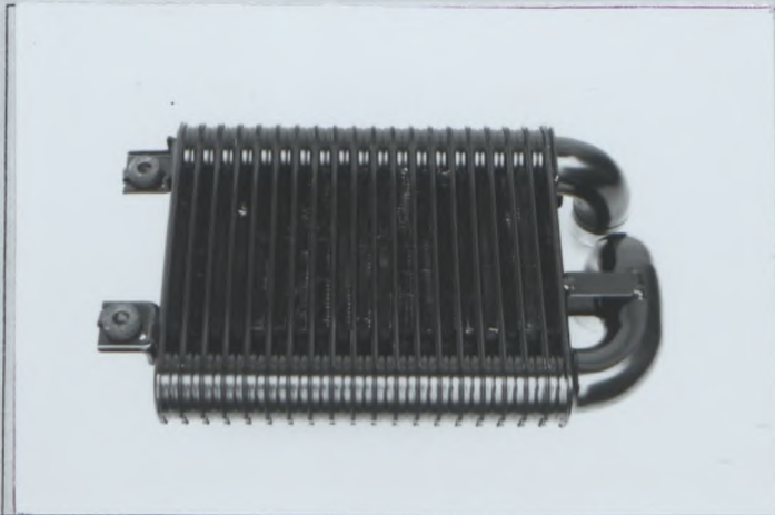
R) Echangeur intermédiaire déposé Intercooler dismounted 取り外したインタクーラ
