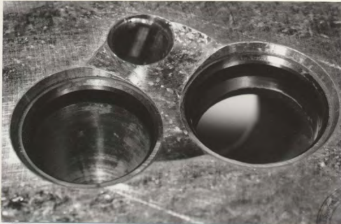
G) Chambre de combustion Combustion chamber
