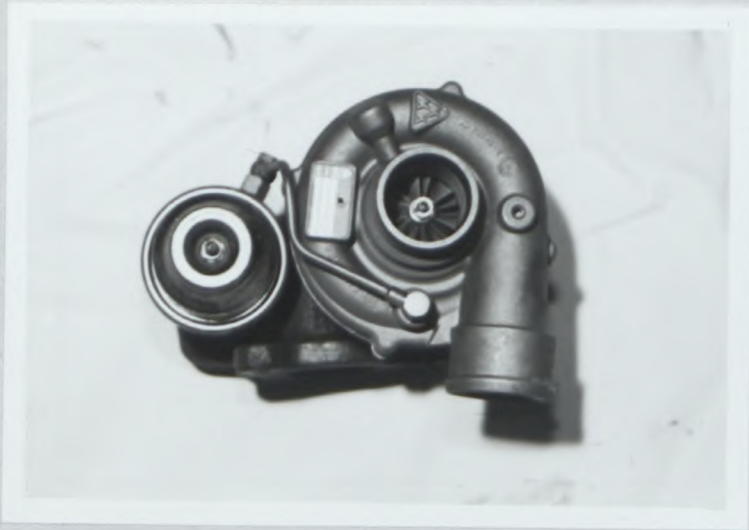
M) Vue de côté du compresseur Side view of compressor
