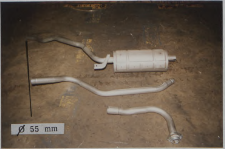
BB) Echappement complet Complete exhaust system
