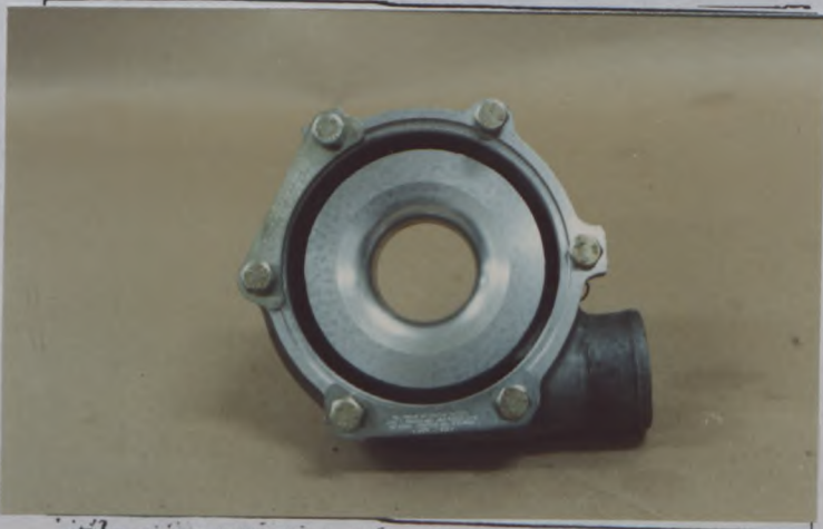
Q) Carter de compression du turbocompresseur Impeller housing of turbocharger
