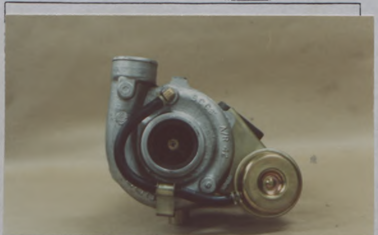
l) Vue de face du turbo compresseur Front view of turbocharger
