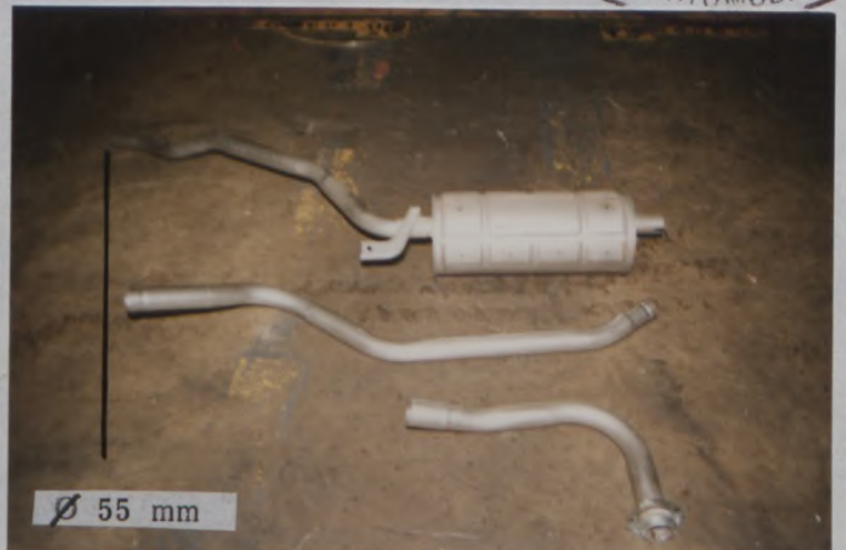
BB) Echappement complet Complete exhaust system
