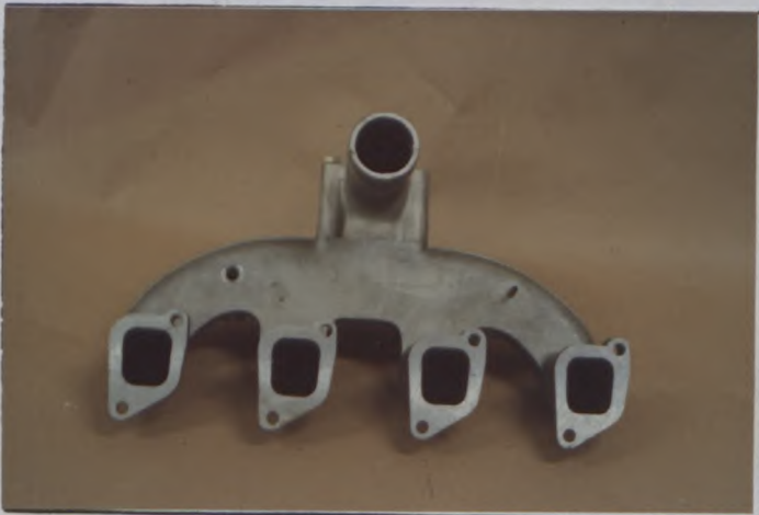
I) Collecteur d'admission Inlet manifold
