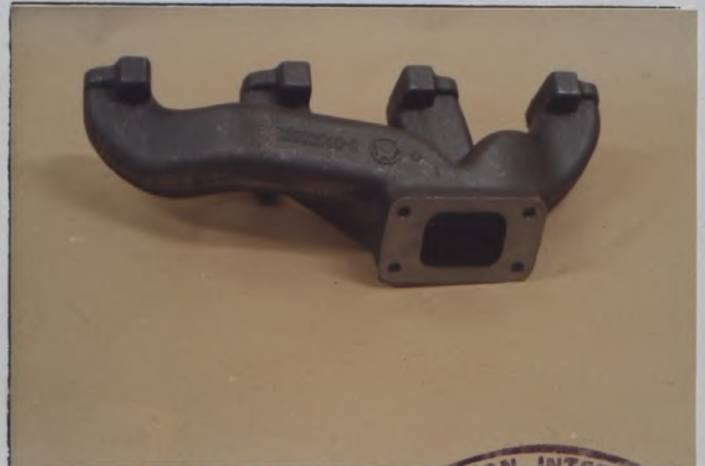
J) Collecteur d'échappement Exhaust manifold
