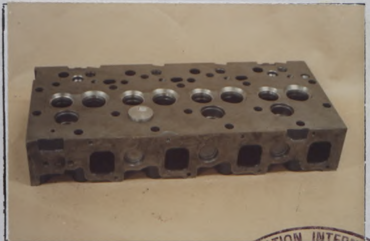
F) Culasse nue Bare cylinderhead
