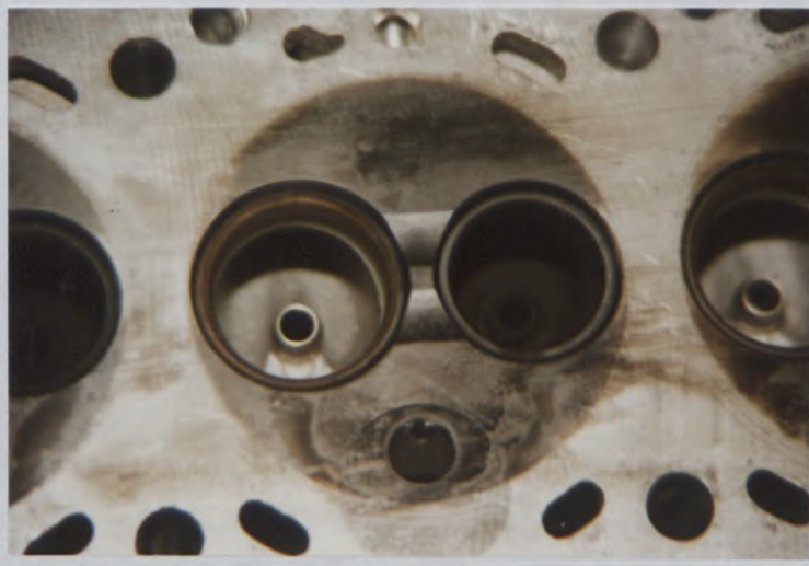
G) Chambre de combustion Combustion chamber
