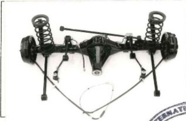
Photo G リアブレーキ、ドラムを取外す. XXXXXXXXXX Rear brake, drum removed
