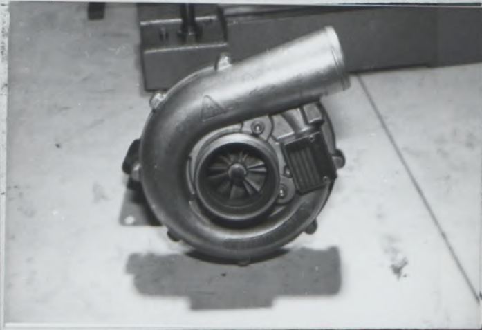
M) Vue de côté du turbocompresseur Side view of turbocharger
