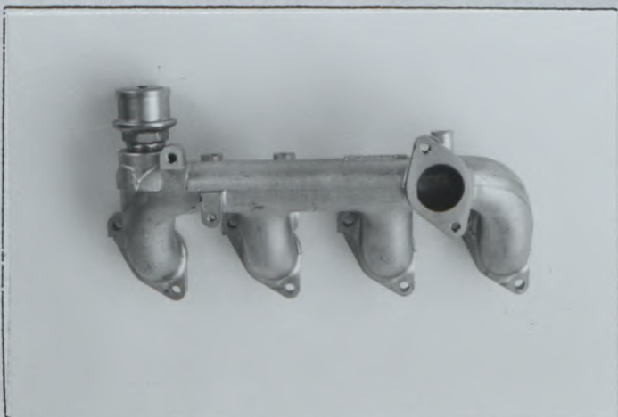
I) Collecteur d'admission Inlet manifold
