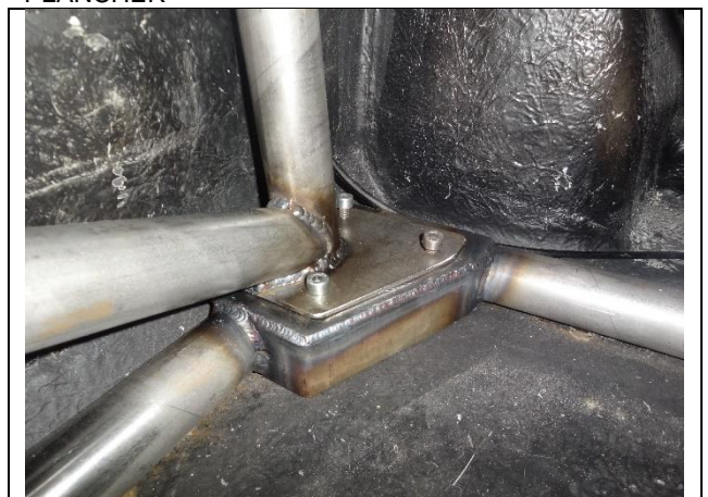
PHOTO 6 FIXATION DE L'ARCEAU DE SECURITE AVANT AU PLANCHER
