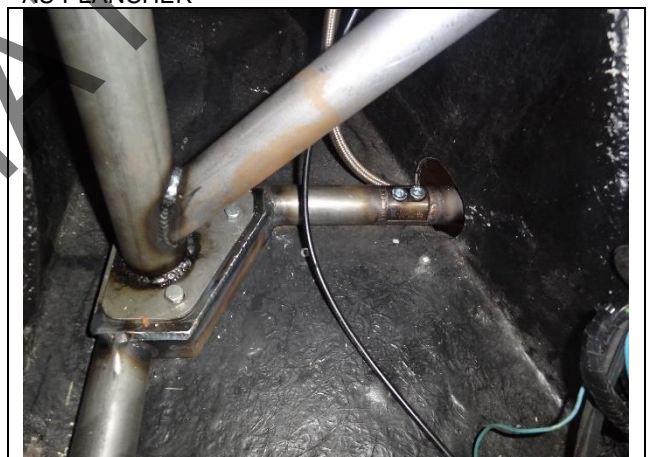
PHOTO 6 FIXATION DE L'ARCEAU DE SECURITE AVANT AU PLANCHER
