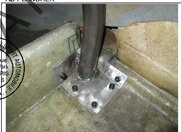
PHOTO 4 FIXATION DE L'ARCEAU DE SECURITE PRINCIPAL AU PLANCHER
