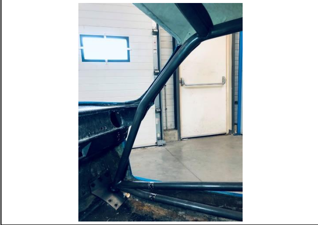
PHOTO 7 FIXATION DE L'ARCEAU DE SECURITE AVANT AU MONTANT "A"
