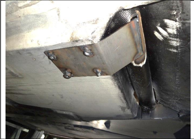
PHOTO 20 Contre-plaque sous châssis arrière.
