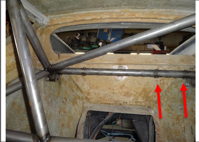
PHOTO 12 FIXATION DES SANGLES D'ÉPAULES – PILOTE
