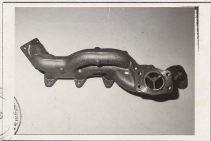
P) Echappement entre le collecteur et le turbocompresseur Exhaust between the manifold and the turbocompressor
