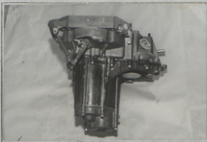
С) коробка передач с картером сцепления Carter de boîte de vitesse et cloche d'embrayage
