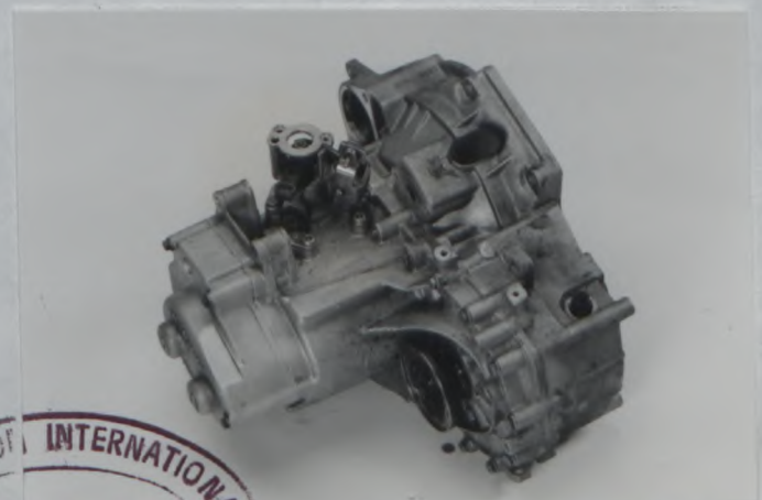
§1) Getriebegehäuse und Kupplungsglocke / Sechsgang Gearbox casing and clutch bellhousing / six speed
