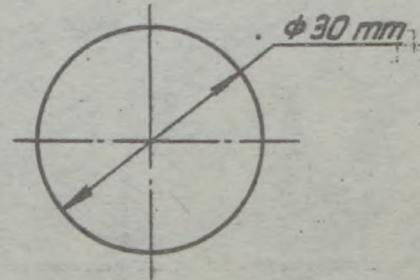
Dessin orifices échappement culasse face collecteur. Indiquez dimensions ou échelle et tolérance de fabrication.
